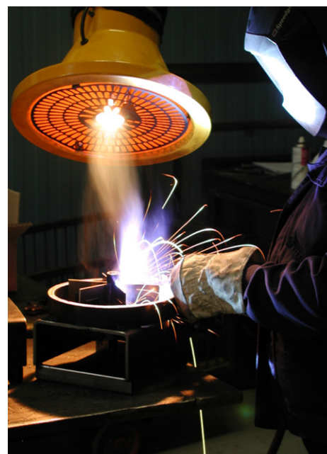
Wing armen kan tilbydes med indbygget lys, start/stop kontakt, manuelt eller motoriseret spjæld
